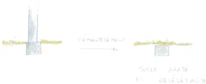
Schéma de principe du traitement des socles de pylônes démontés
